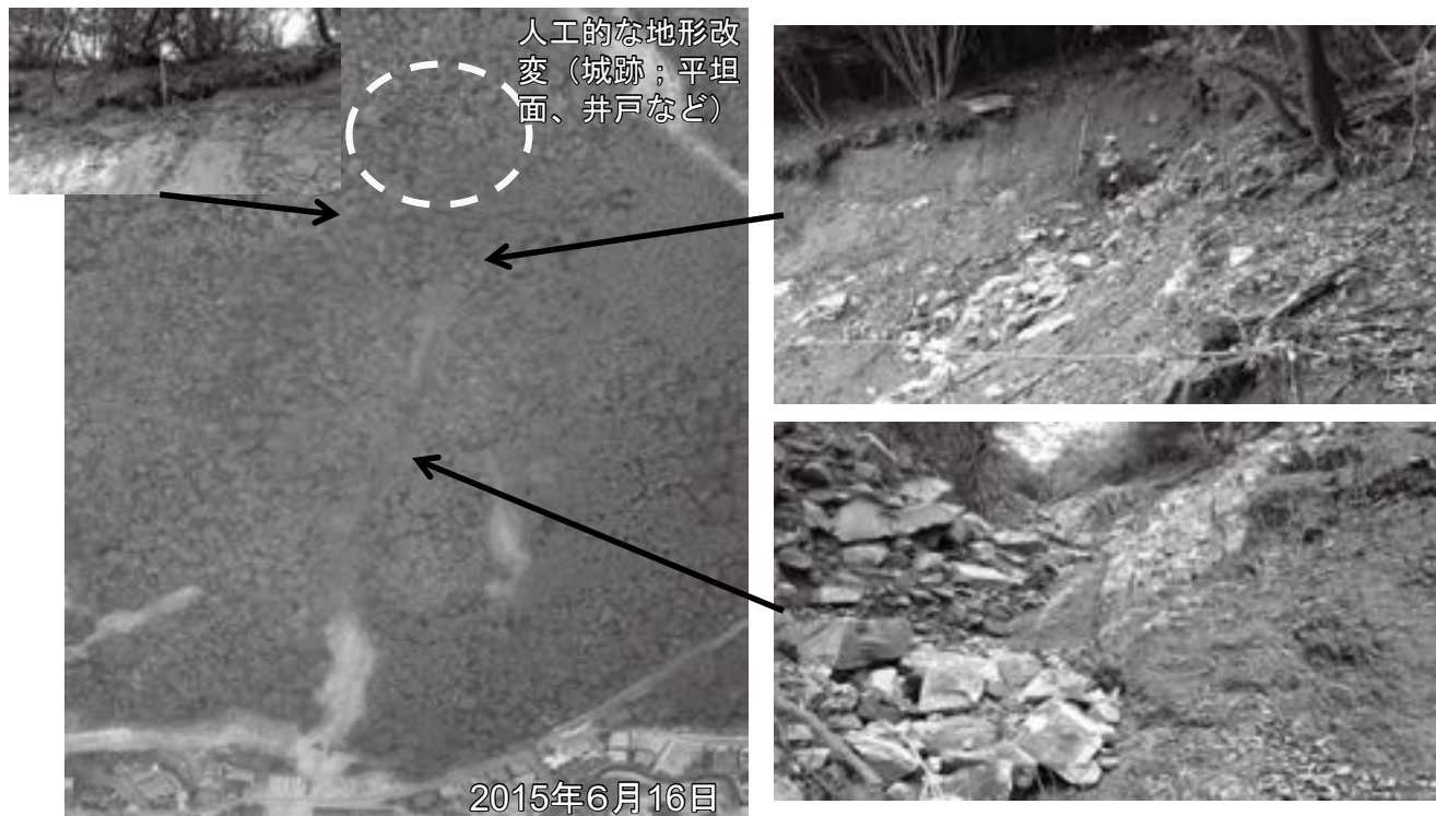
図2 災害後のドローン画像（地形補正したもの）と土砂移動の発生箇所状況
